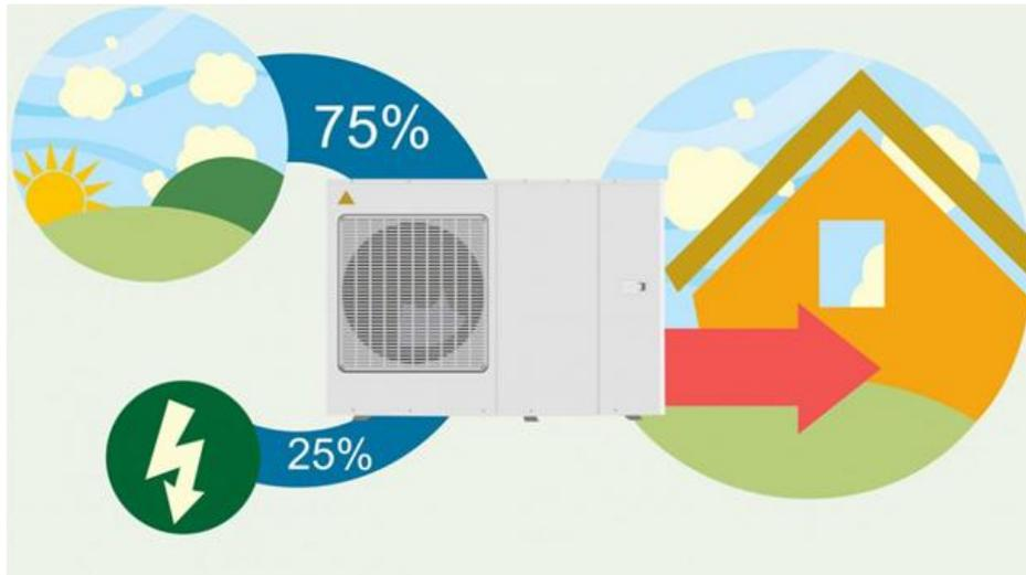
Es un sistema climatización integral mediante energía renovable para la producción de calor y frío de manera muy eficiente, capaz de producir por cada kW de electricidad consumido entre 3 y 5 kW de energía para su hogar, lo cual le convierte en una opción más barata que los sistemas tradicionales, proporcionando calor con una eficiencia hasta 5 veces superior a la de un sistema de calefacción tradicional, basado en combustibles fósiles o en energía eléctrica.
